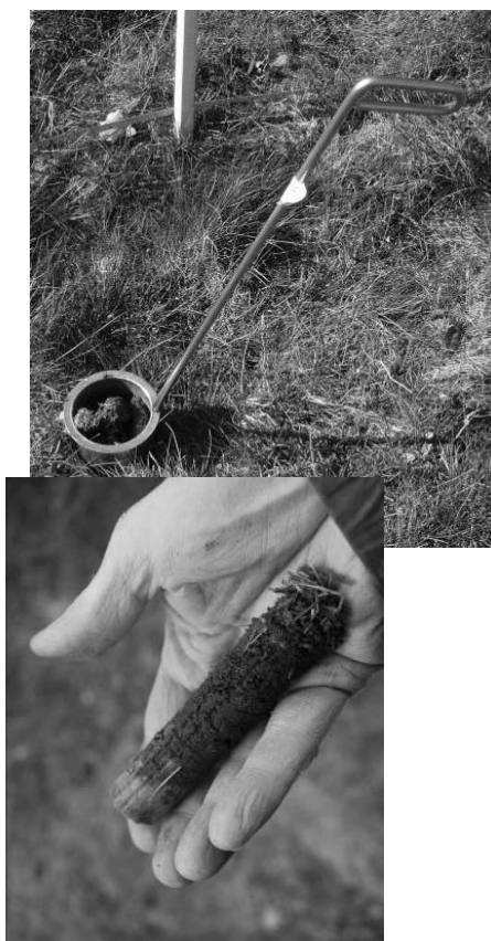
Figur 2: Foto af golfbaneprøvetager (tv.) til udtagning af cylinderformede increments (th.), increment-størrelse 10 cm, \varnothing 25 mm, svarende til ca. 80 gram jord.
