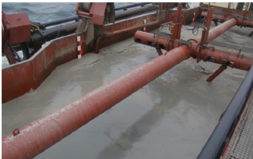
Figur 2.0.2: Lastemærke i lastrum og tydelig sandoverflade til kontrol af mængden af sand i lasten.
